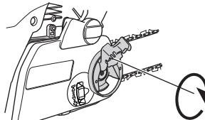
При установки новой цепи следует часто проверять ее натяжение , пока цепь не приработается. Регулярно проверяйте натяжение цепи. Регулярно проверяйте натяжение цепи. Правильно натянутая цепь обеспечивает высокое качество пиления и дольше служит.
