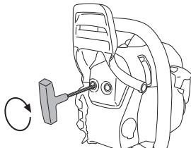
В некоторых глушителях предусмотрен специальный искрогаситель. Если ваша машина оборудована таким глушителем, сетку фильтра следует чистить раз в неделю. Наилучшие пользуются стальной щеткой. Забитая решетка приводит к работе с горячим двигателем, что дает серьезные повреждения двигателя.
