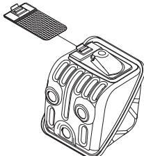
Глушитель служит для снижения уровня шума и отвода раскаленных выхлопных газов от рабочего. Выхлопные газы очень горячие и могут содержать искры, что может привести к пожару при прямом попадании на сухой и воспламеняющийся материал.
