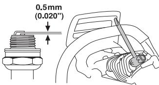
Обратите внимание! Всегда используйте только указанный тип свечи! Применение несоответствующей модели может привести к серьезным повреждениям поршня/цилиндра. Следите за тем, чтобы свеча была оснащена т.н. изоляцией радиопомех.
