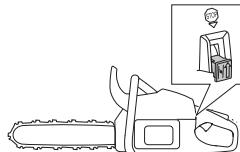
**ПОМНИТЕ!** Выключатель Запуск/Остановка автоматически переходит рабочее положение. В целях избежания непроизвольного запуска, головка свечи должна быть всегда снята со свечи при сборке, проверке и/или обслуживании.
