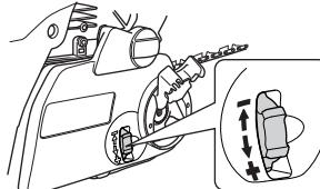
Цепь считается натянутой правильно, если она свободно проворачивается рукой. После этого, удерживая носок пильного полотна в верхнем положений, затяните гайки крепления пильного полотна универсальным ключом.
