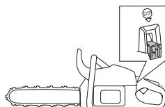
**ПОМНИТЕ!** Выключатель Запуск/Остановка автоматически переходит рабочее положение. В целях избежания непроизвольного запуска, головка свечи должна быть всегда снята со свечи когда вы оставляете машину без присмотра.
