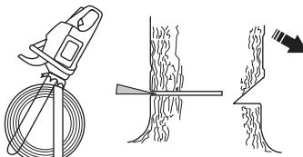
Закончить основной пропил нужно параллельно линии направляющего пропила так, чтобы расстояние между ними составляло около 1/10 диаметра ствола. Нераспиленный участок ствола называется полоса разлома (недопил).
