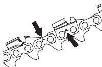
Для определения степени износа цепи мы рекомендуем проводить визуальное сравнение с новой цепью.
