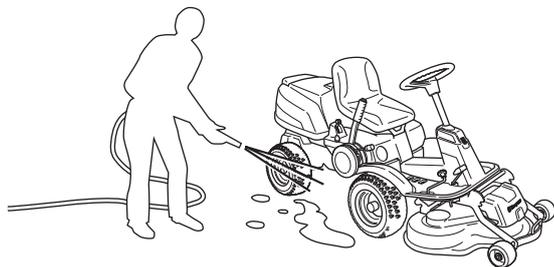
Масляные загрязнения могут быть удалены с помощью обезжиривающего средства. Разбрызгайте обезжиривающее средство на загрязненную поверхность тонким слоем.
