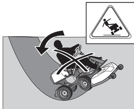
или насыпи. Машина может неожиданно опрокинуться, если одно колесо наедет на крутой склон или попадет в канаву, или если край канавы обвалится.
